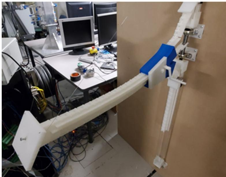
FIGURE 5.14 – Poutre déployée en utilisant quatre câbles en tension
