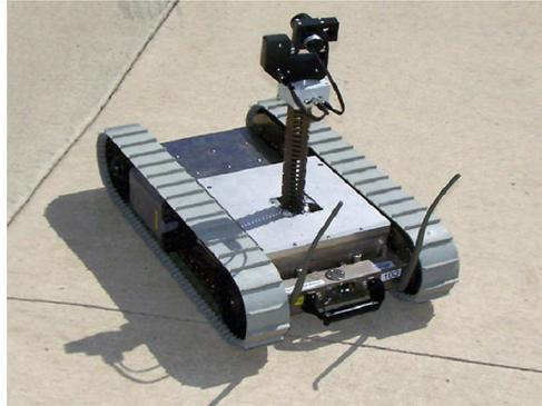
FIGURE 0.5 – Poutre rétractable s'inspirant du principe de la fermeture éclair utilisant des chaînes : le Zippermast (13)
