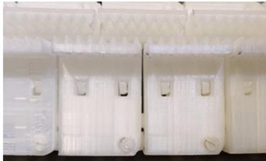
FIGURE 5.22 – Jeux entre les maillons causant la flexion de la poutre
