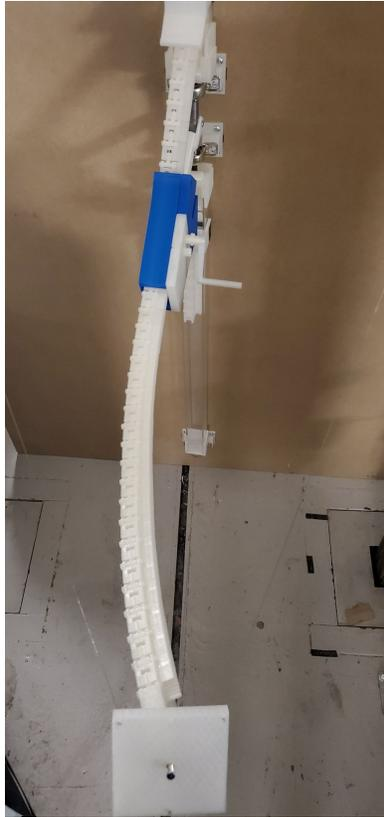
FIGURE 5.20 – Flambage de la poutre
