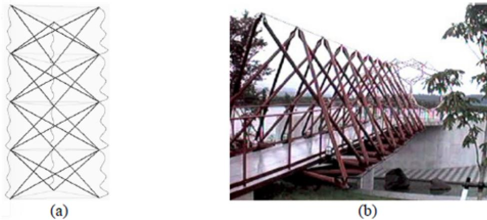
FIGURE 0.3 – Structure déployable contrôlée par des câbles actifs et passifs : a) idée générale
